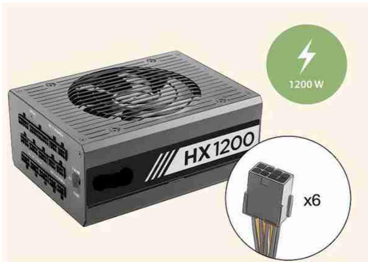
??选择1200W电源。如果需要运行6张显卡，则至少需要1200瓦的电源才能支持系统的总功耗。大功率电源在波动的情况下有10%到15%的缓冲区。
