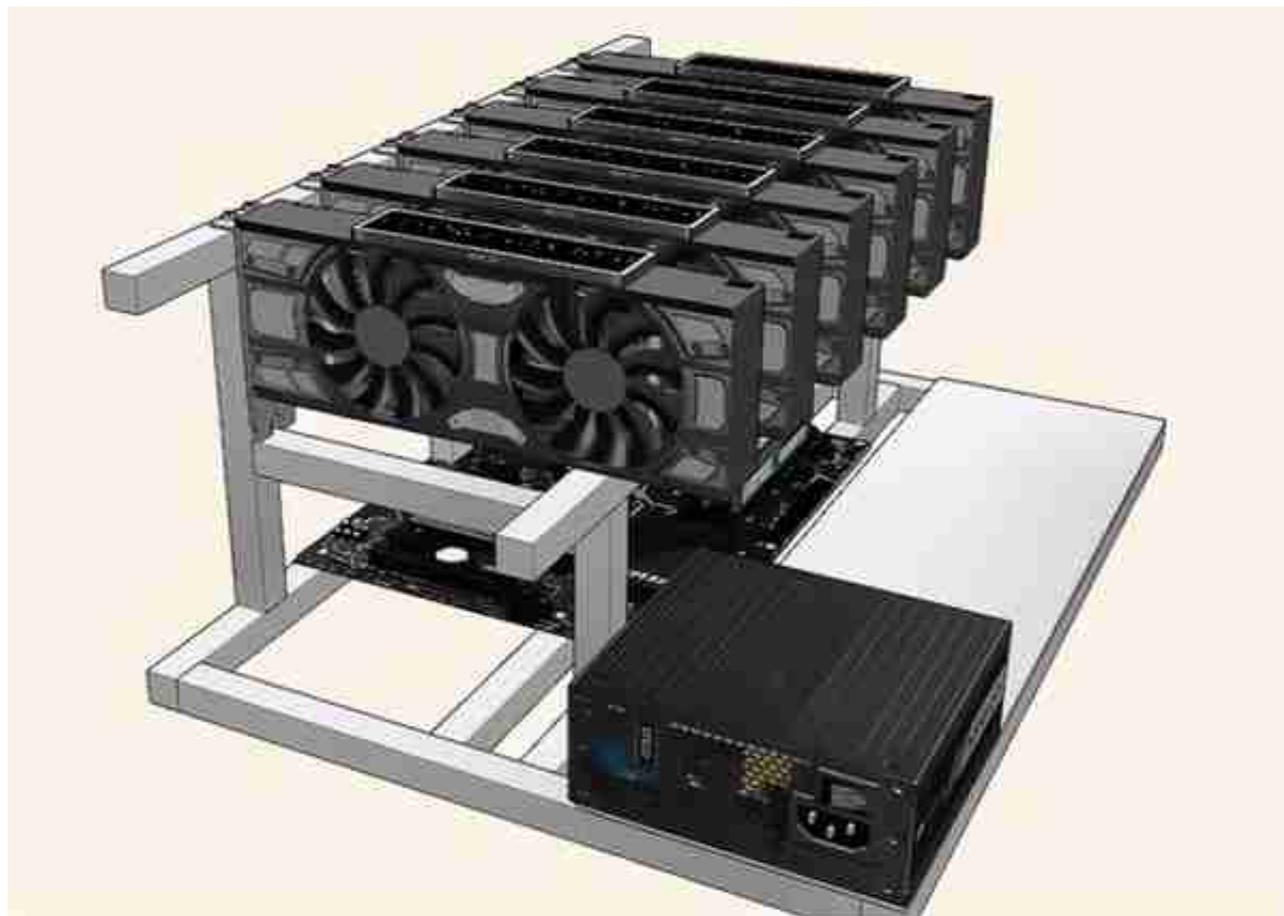
运行6个GPU会产生大量的热量。与带风扇的封闭式机箱相比，露天壳体为矿机提供了更好的冷却效果。使空气在GPU周围保持循环可确保最佳性能。
